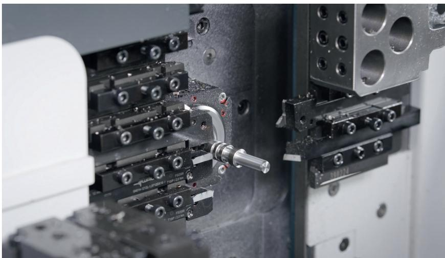
5 Zum Abstechwerkzeug für Langdrehmaschinen G4014-P gehören eine Präzisionskühlung zur Standzeitverlängerung und 'Smartlock' für einen fixen Schneideinsatzwechsel
